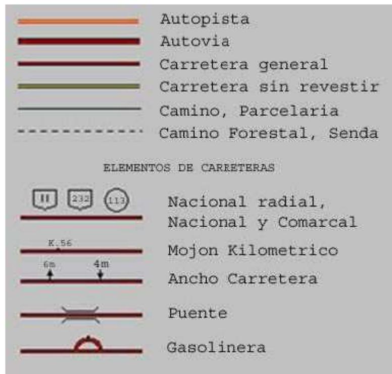
En la figura se muestran los símbolos convencionales más usados para la representación de carreteras y caminos. También se muestran los símbolos utilizados para señalar los distintos elementos que pueden encontrarse en una carretera como los mojones kilométricos, los puentes y las gasolineras. La categoría de la carretera se establece mediante un símbolo en cuyo interior figura la denominación numérica de la vía.
